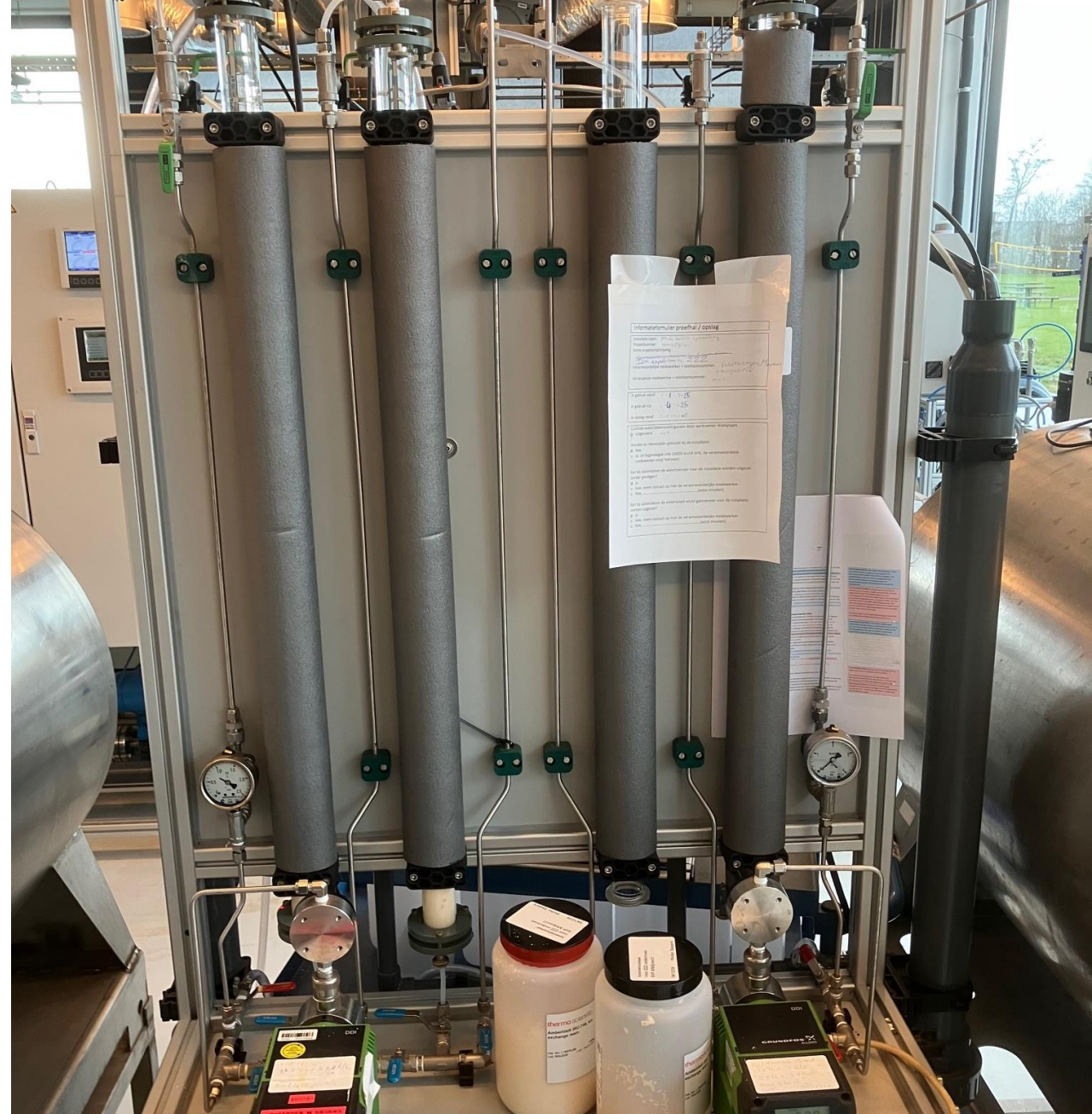
Kolomopstelling met 2 x 2 kolommen en twee pompen
